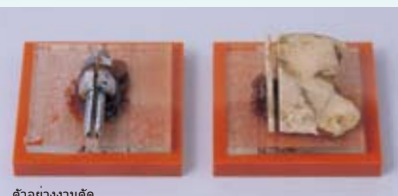
ตัวอย่างงานตัด *ให้ความร้อนโดยใช้เครื่องเป่าลมร้อนอุตสาหกรรม หรือใช้แผ่นร้อนก็ได้
